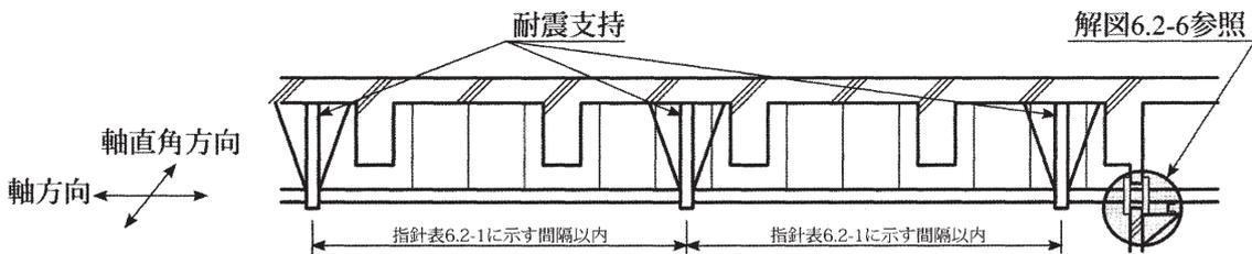
解図 6.2-9 電気配線の軸方向の支持例
