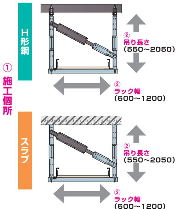
吊り長さが1100mmを超える場合、専用架台と組み合わせてご使用ください。
