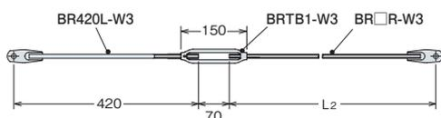
・右ねじ長さ(L2)は、耐震支持間隔及びラック幅(W)により算出します。計算式は次の通りです。
