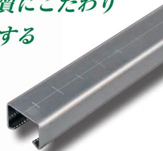
配管支持、サポート材として幅広く使用されているダクターチャンネル。ダクタークリップの引っ掛かりが良く、滑りにくい溝加工を施しています。ダクタークリップとの適合を考えた溝にすることで配管の滑落を防いでいます。
