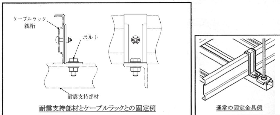
図 6.3-2 親桁の固定例
