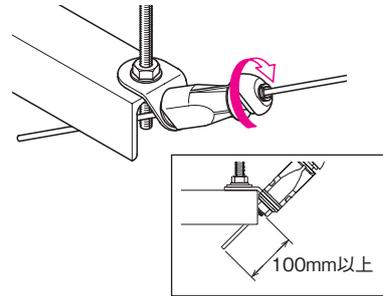
⑥ 上部のボタンを回してロックを掛けて施工完了です。
