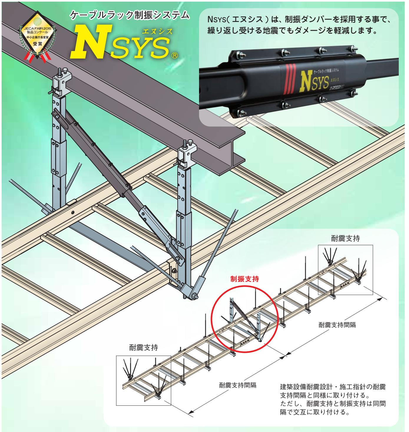
建築設備耐震設計・施工指針の耐震支持間隔と同様に取り付ける。ただし、耐震支持と制振支持は同間隔で交互に取り付ける。
