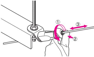
ワイヤーの張力の調整が必要な場合は、ボタンをゆるめてから押し込むことで調整できます。
