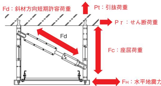
水平地震力(F<sub>H</sub>)が制振支持材に掛かると、各部材に応力が掛かる為、それを各パーツごとで検討しています。
