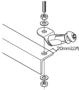
② サポート材に止め金具を取り付けます。サポート材に穴あけが必要な場合は、端から20mm以内にあけてください。
