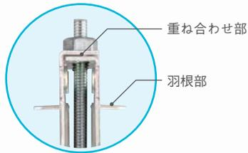
様々な設備を支持する際に使用する吊りボルト支持金具。地震等で過大に荷重がかかった場合に備えてより変形を抑え本来の強度を保つ工夫が、金具上部の重ね合わせ構造です。羽根部の変形を抑え重要な設備の落下、破損を防ぎます。
